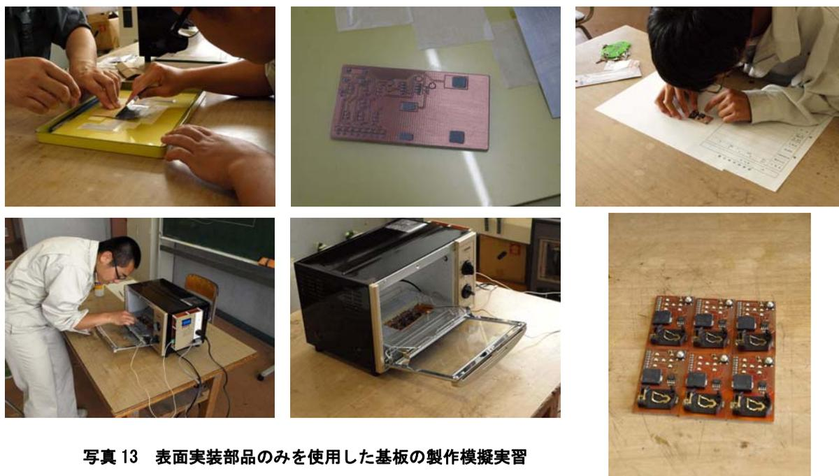
写真 13 表面実装部品のみを使用した基板の製作模擬実習
