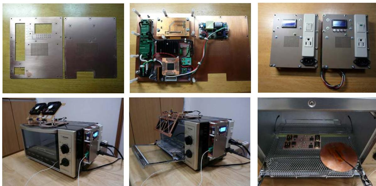
写真 10 製作したリフローコントローラと可倒式冷却装置
