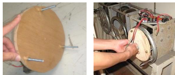
図7 ハンドル取り付け部と動作確認
