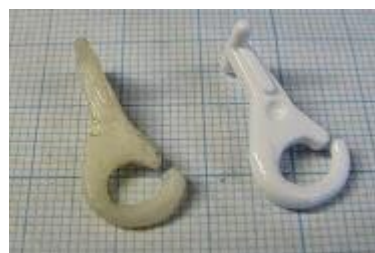
電車模型の連結器を製作 左が製作したもので右が正規品
