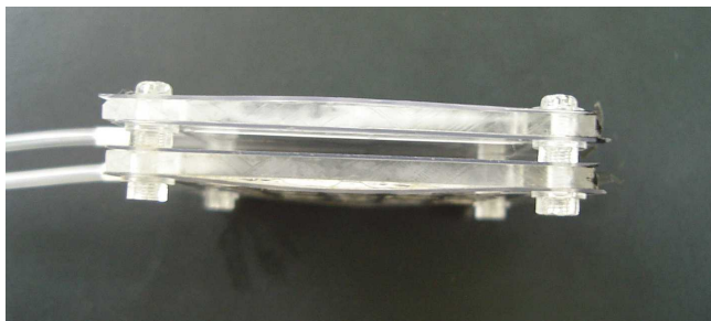
図31 上から見た図 2枚の燃料電池に分離
