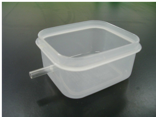
図10 プラスチックの容器にポリ管をはめる
