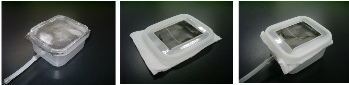
図15 プラスチックの容器に金網・キッチンペーパー・金網をのせ、フタをはめ込む
