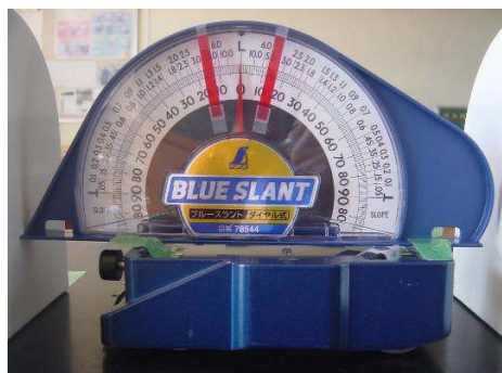
図 19 傾斜計を用いた簡易加速度計 赤いフィルムが 11.5^\circ を示す
