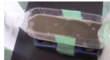
図16 液状化した状態
