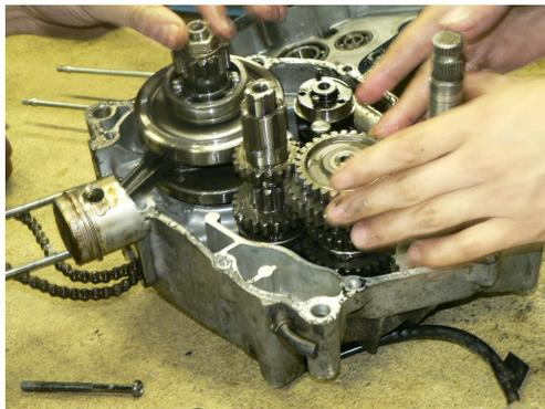
図16 変速ギアの確認
