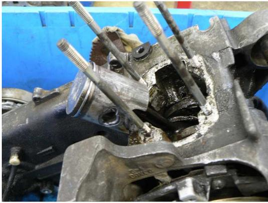
図5 シリンダブロックの取り外し
