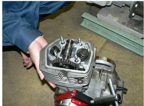
図13 ヘッドカバーを取り外した状態
