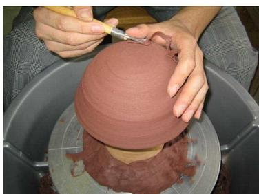
図1 器部分の底は曲面に削る
