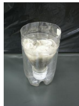
図1 手作りベールマン装置
