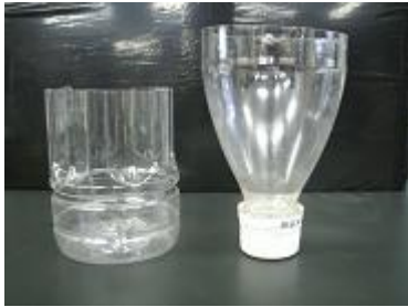
図4 手作りベールマン装置
