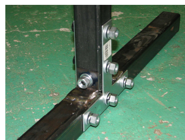
図 27 支柱部材との接合確認
