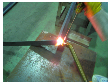
図 19 掲示板枠の溶接作業
