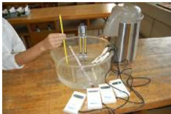
**図2** 各温度計の器差を測定している様子
