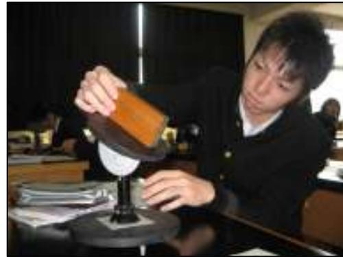
図11 前時のクリノメーターを使った測定実習 (左: 走向 右: 傾斜)
