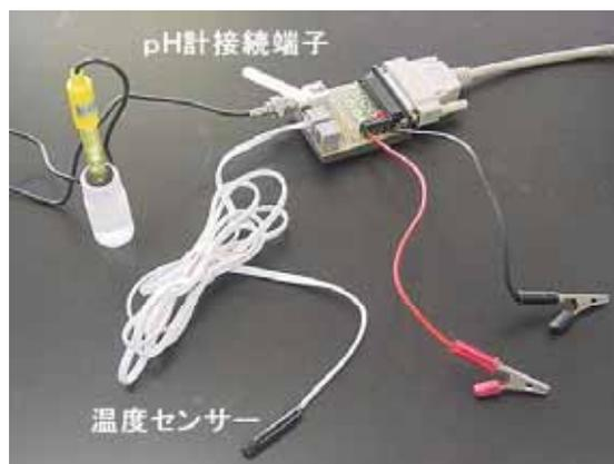
図2 各計測モジュールを接続した様子
