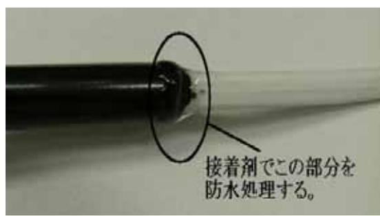
図4 温度センサーの防水処理
