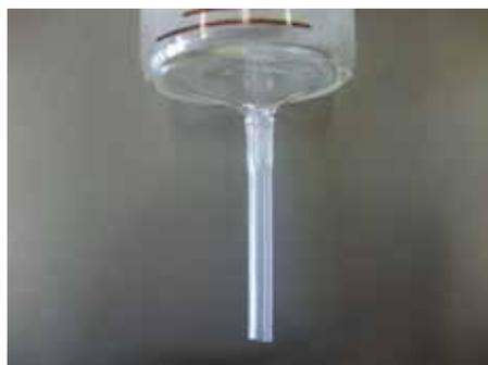
図 21 シリンジの先端にシリコン管を付けた様子
