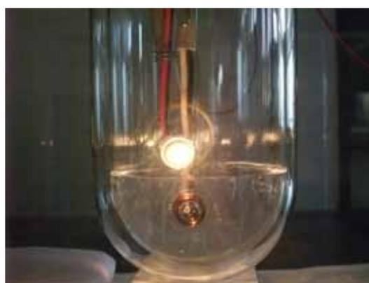
図30 エナメル線を液体窒素で冷却して明るく点灯した豆電球
