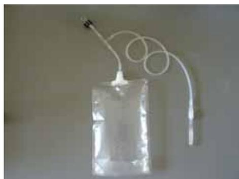
図10 酸素のカートリッジを外してシリコン管をダブルクリップで止めた状態
