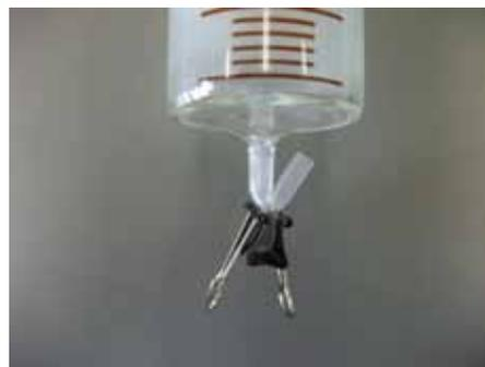
図 22 ダブルクリップで先端を閉じた様子
