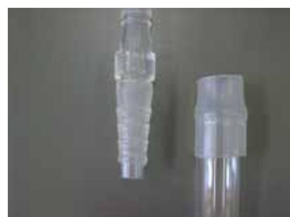
図12 チューブコネクタと試験管の接続部分の構造
