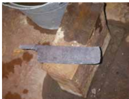
図3 鍛造成型完了
