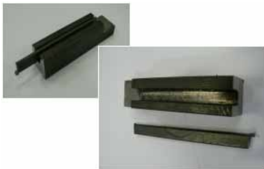
図14 白紙2号鋼と溝入れ母材S45Cと組み合わせ
