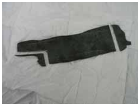
図17 コンタマシンで余分な部分を切り取る
