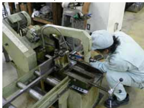
図12 材料の切り出し作業
