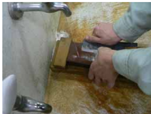
図22 砥石にて刃付け作業
