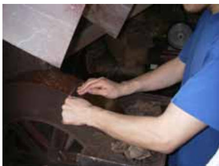
図8 回転砥石にて刃付け成型
