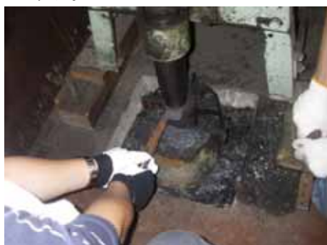
図2 スプリングハンマーを用いて鍛造
