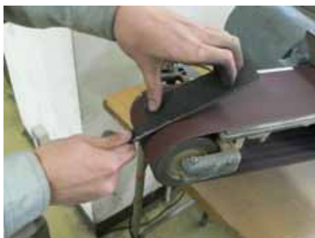
図18 ベルトサンダーにて表面処理作業
