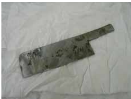
図19 庖丁表面の酸化皮膜を剥がす
