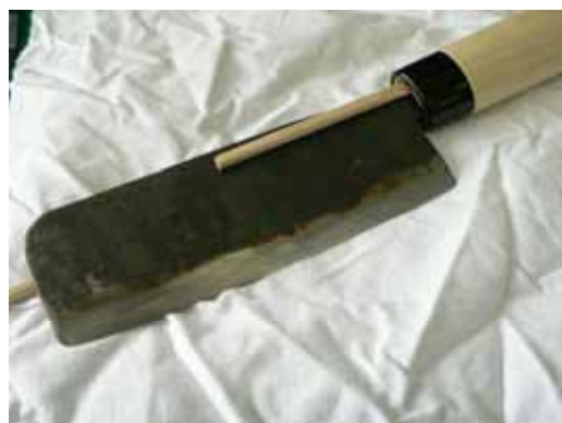
図24 刃と柄の間に修正材を入れ調整
