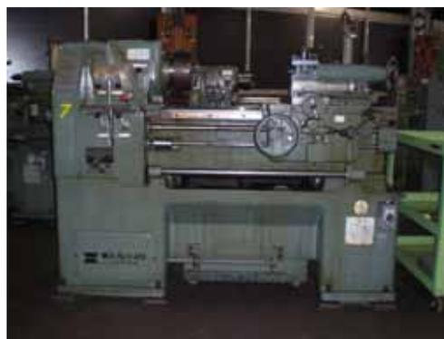
図1 実習で使用している WASINO 製 4 尺旋盤
