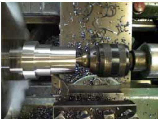
図7 中削り加工の様子
