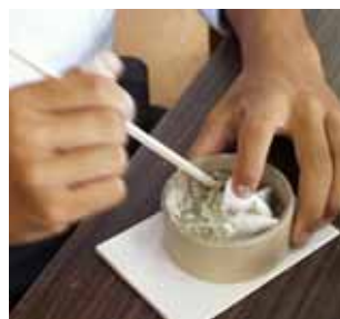
写真18 型枠に砂をつめる 写真19 砂型完成
