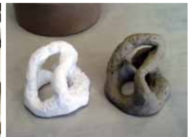
写真16 カッターで整形 写真17 スチロール原型と粘土原型
