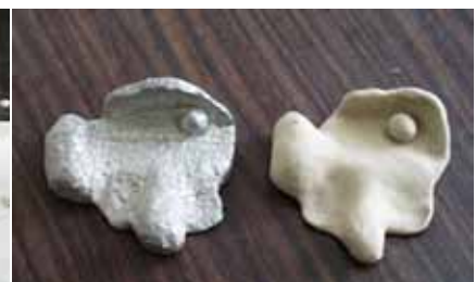
写真 21 金工のこぎりで湯道切断 写真 22 仕上げ前の金属作品と粘土原型
