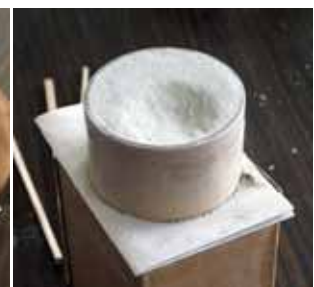
写真18 型枠に砂をつめる 写真19 砂型完成
