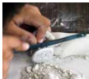
写真 21 金工のこぎりで湯道切断 写真 22 仕上げ前の金属作品と粘土原型
