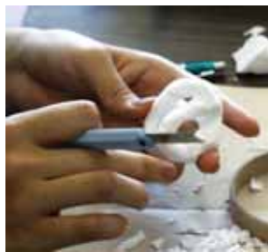
写真16 カッターで整形 写真17 スチロール原型と粘土原型
