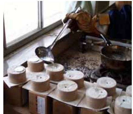
写真 20 鑄込み時は熱に注意する
