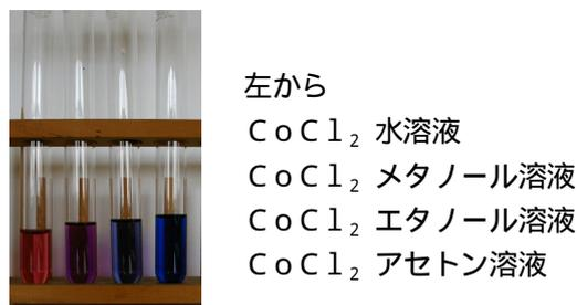
図3 塩化コバルト( )のソルバトクロミズム
