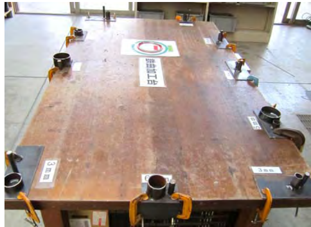
鉄曲げ加工台・補助具（3，4，5，6mm用）
