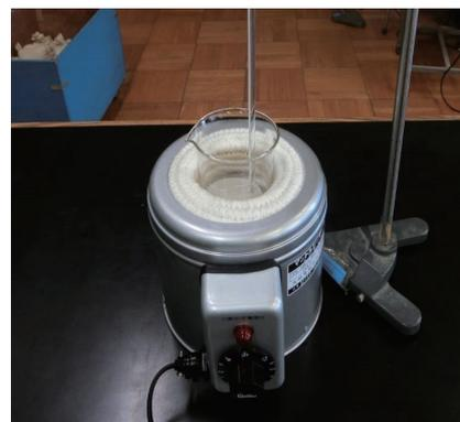
図2 マントルヒーターによる加熱
