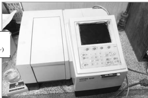
図 5 分光光度計による吸光度の測定
