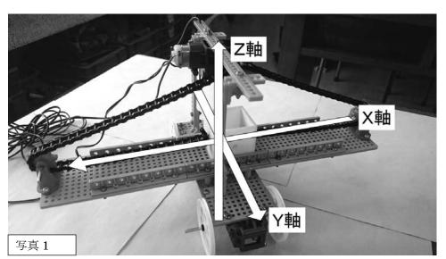
この装置を使って、台車が走行している間に錘が一端から他端に X 軸方向に移動する時の台車の 三次元的な加速度を計測した。そこから運動量を計算した
